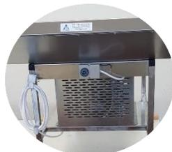
Le refroidissement de la table est assuré par un serpentin, noyé, en tube cuivre 3/8, la détente du fluide frigorigène s'effectue par capillaire. Le fonctionnement du groupe frigorifique est asservi à un thermostat. Un bac en pvc positionné en dessous de la table permet de récupérer les condensats.
